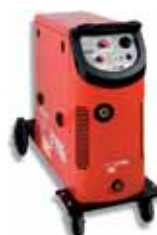
Soldador hilo solter Aero MIG 280. Campo de regulación: 20-250 A. Diámetro del hilo: 0,6-1 mm. Bobinas de 5 a 15 kg. 1.650€
