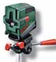
Nivel con trípode láser Bosch PCL 20. Diodo 635 mm. Precisión: ±5 mm/m. Alcance: 20 m. Nivel láser cruzado. Autonivelación. Incluye: funda, trípode 1,5 m y adaptador de paredes. 163€
