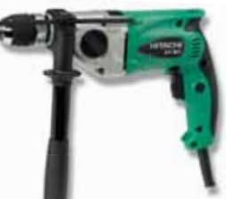
Taladro Hitachi DV18v. 690 W de potencia. Percutor. Portabrocas 13 mm sin llave. Capacidad hormigón 18 mm, acero 13 mm, madera 40 mm. 2 velocidades. 138€
