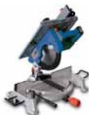
Ingletadora Dexter 250 mm. 1.800 W de potencia. Diámetro del disco: 254 mm. Capacidad de corte: 75 mm (a 90°) y 50 mm (a 45°). Disco de metal duro 36 dientes, abatible hasta 45° para cortes a bisel. Con sistema de aspiración. 189€
