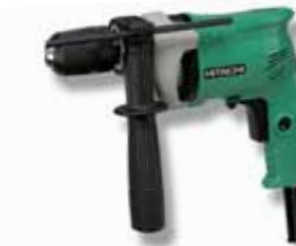
Taladro Hitachi DV16VSS. 600 W de potencia. Portabroca 13 mm sin llave. Velocidad variable y reversible. Peso: 1,5 kg. Incluye un tope de profundidad, una empuñadura auxiliar y maletín. 96,41€
