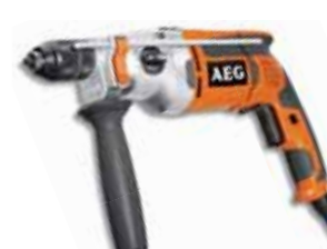
Taladro AEG SB20-2E. 750 W de potencia, 2 velocidades, embrague de seguridad, portabrocas automático de 1,5-13 mm. 56 Nm de par de apriete. Incluye tope de profundidad. Peso: 2,8 kg. 204€
